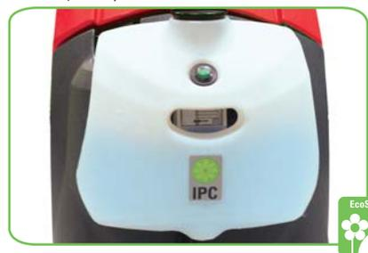
Система дозирования мощного средства, отдельная от подачи воды. Обеспечивает значительную экономию раствора. Полностью съемный бак.
