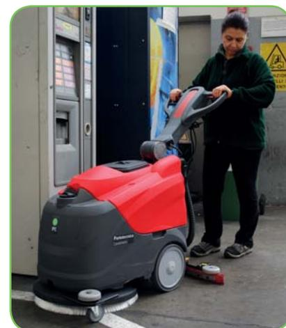
Поломоечные машины с дисковой щеткой
