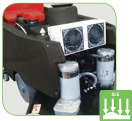
Привод щеток при помощи высококачественного механизма, гарантирующего постоянное прижатие к полу.
