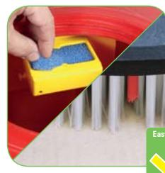
Зоны технического обслуживания помечены желтым цветом. Щетки оснащены индикатором максимального износа.
